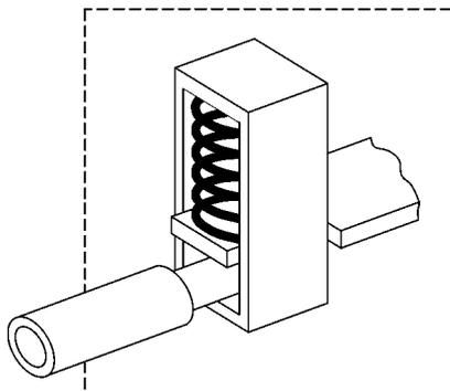
schraubenlose Klemme mit indirekter Druckübertragung
