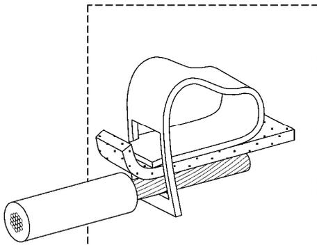
schraubenlose Klemme mit direkter Druckübertragung
