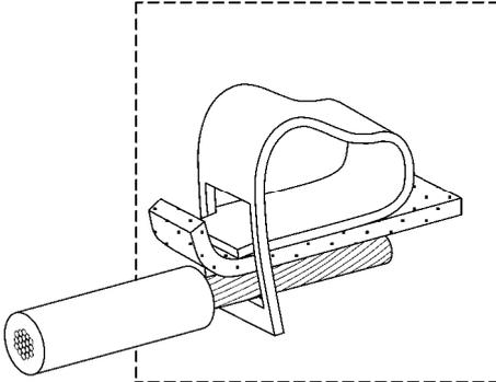
schraubenlose Klemme mit direkter Druckübertragung
