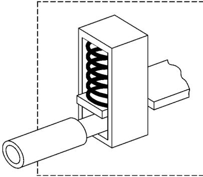
schraubenlose Klemme mit indirekter Druckübertragung
